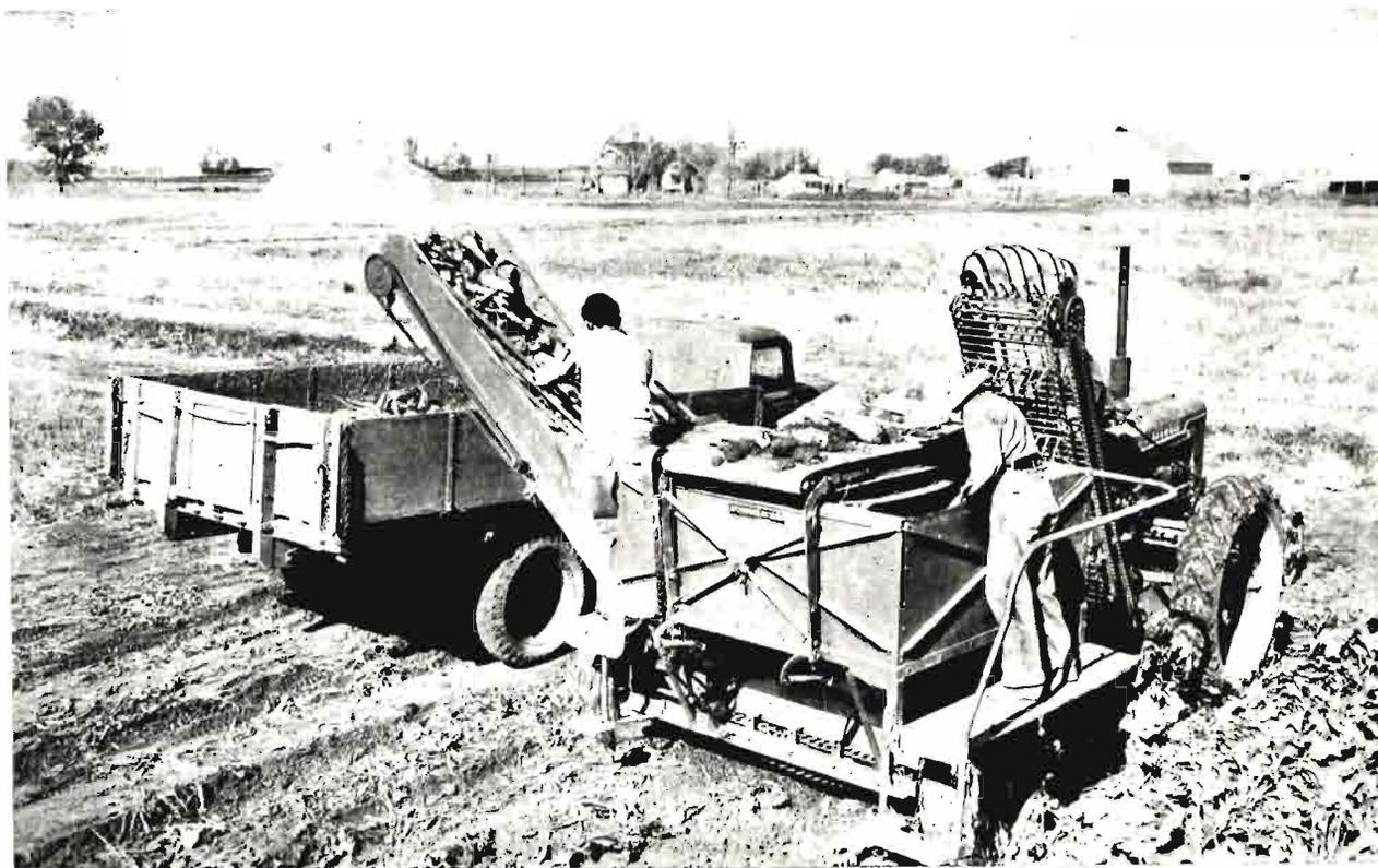
La mecanización.—Cosechadora de remolacha, remolcada por tractor Farmall M, que sucesivamente descorona, arranca y carga las remolachas sobre un camión.
