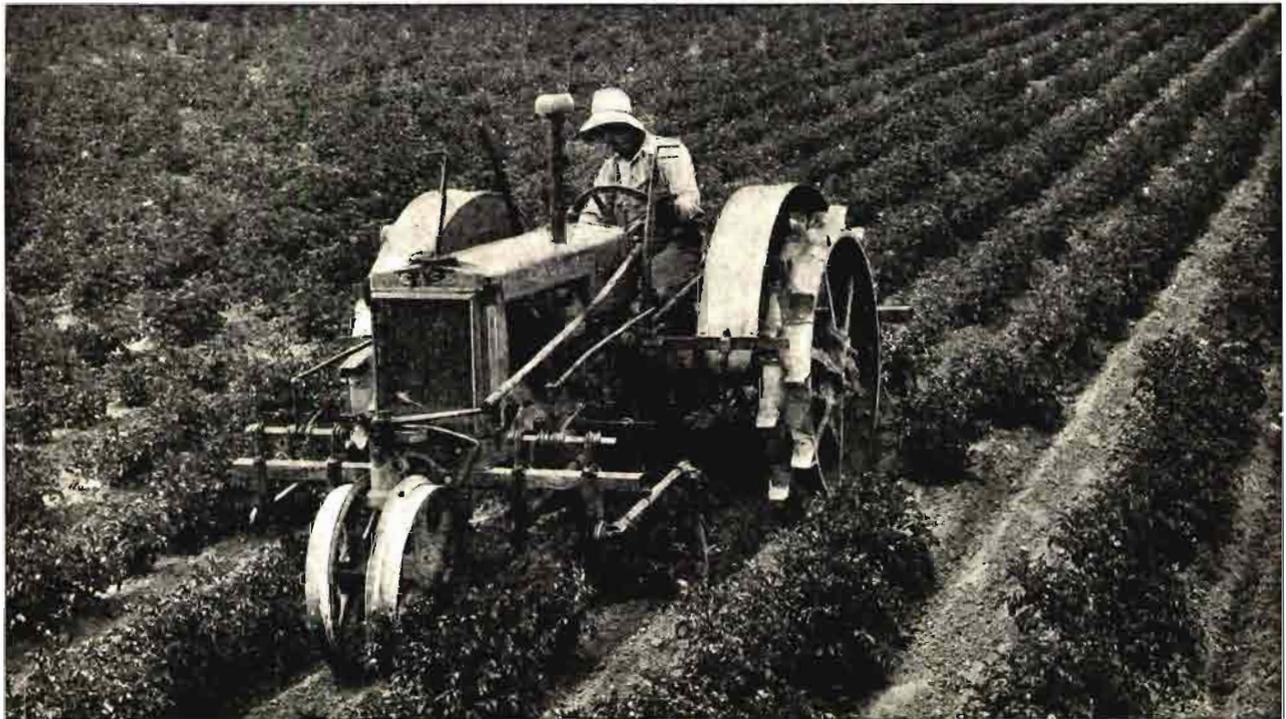
Las labores se realizan perfectamente con tractores especiales que marchan entre las líneas de patatas y llevan las piezas de trabajo montadas sobre su propio bastidor, para girar en un radio muy corto al final de los surcos.
