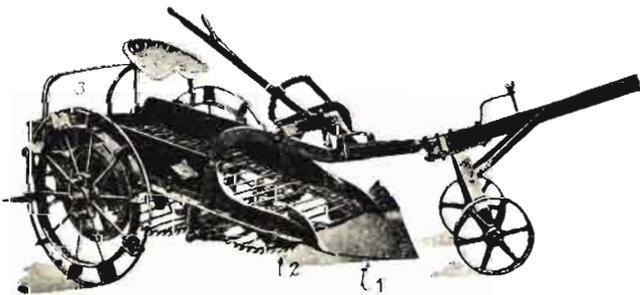
Otras arrancadoras, en vez de lanzar violentamente la tierra de los lomos levantada por la reja (1), hacen la limpieza de las patatas al recibir la carga en el elevador de varillas (2), de modo que es fácil recogerlas en sacos al caer por el extremo (3) más alto.
