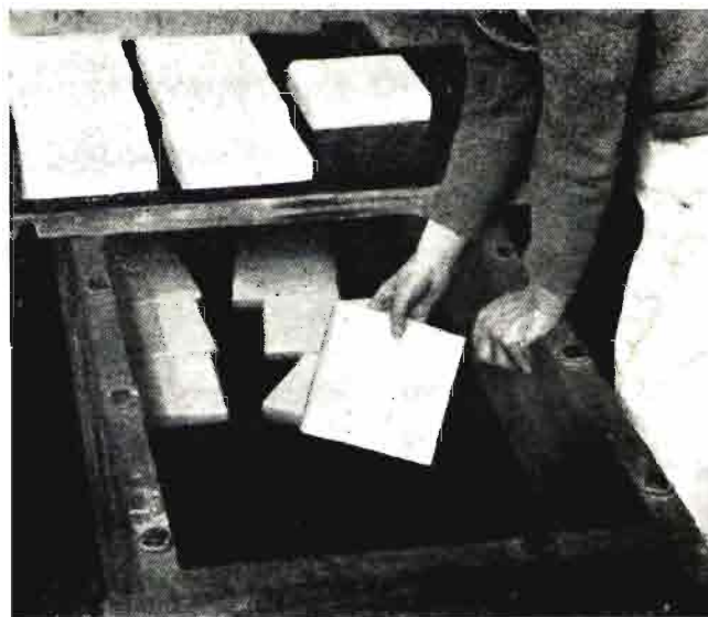
Fig. 7. a —Sacado de los quesos del tanque de salmuera, dejándolos escurrir un poco de tiempo para eliminar el exceso de líquido; el tanque puede ser de cemento, ladrillo o madera
