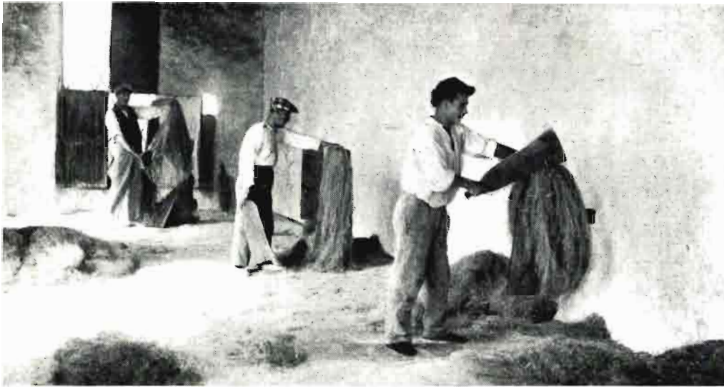
Con el descolado y el raspado se logra eliminar casi totalmente la gramiza y las colas y dar movilidad a la fibra.
