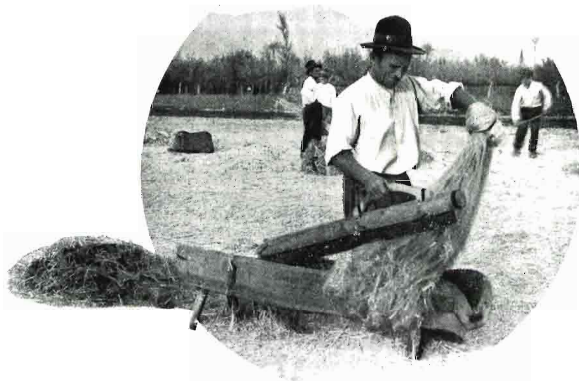
El agramado en la vega baja del Segura se realiza con este sencillo artefacto, conocido con el nombre de «sagramaderas».
