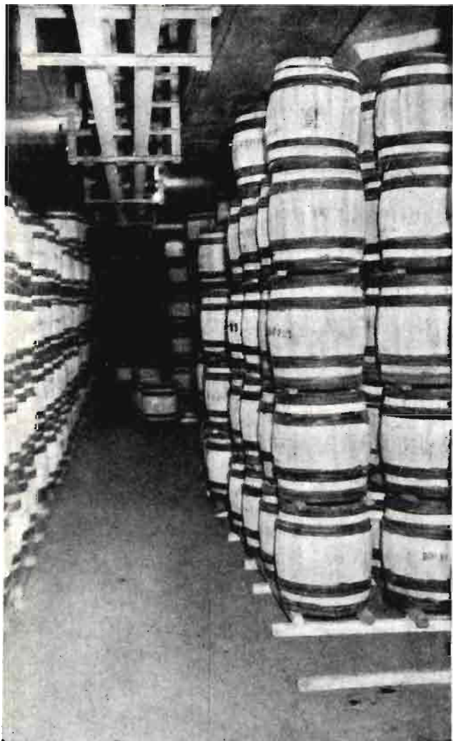
COLOCACION DE LOS BARRILES EN LA CAMARA. —Con el fin de favorecer la circulación del aire alrededor de todos y cada uno de los barriles, en las cámaras, la Sección de Cuarentenas del Ministerio de Agricultura, de los Estados Unidos, dictó las disposiciones convenientes que se observan en esta fotografía.
