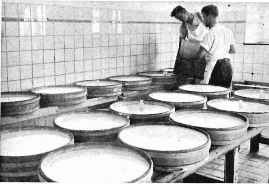
En estas vasijas planas de madera se encuentran las muestras de leche suministrada por los granjeros. Los frascos colocados encima contienen las muestras para ensayos microscópicos.
