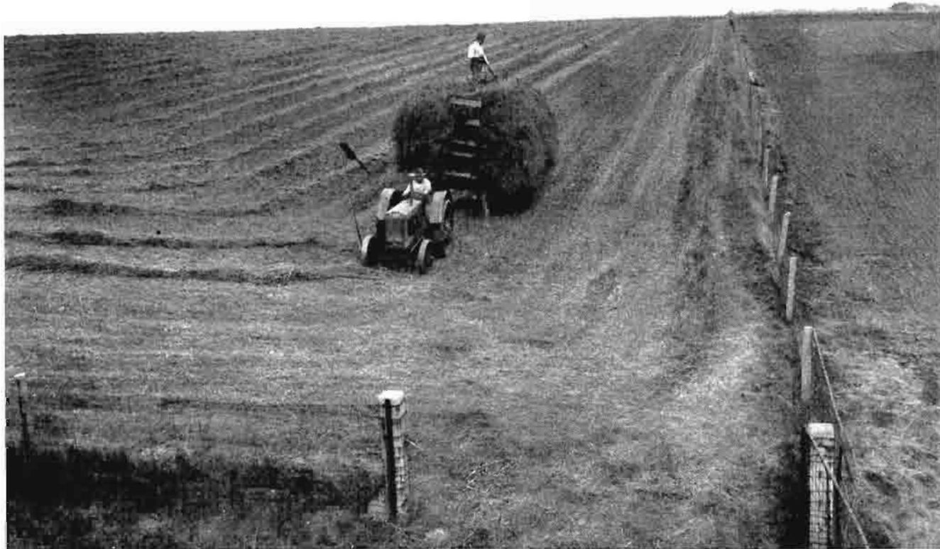
TRANSPORTE.—Este tractor, con su barca de guadaña, segó la pradera, quizá luego hizo las hileras de heno remolcando un ancho rastrillo de descarga lateral y ahora completa la recolección llevándose la cosecha en un remolque provisto de utilísimo cargador de heno.
