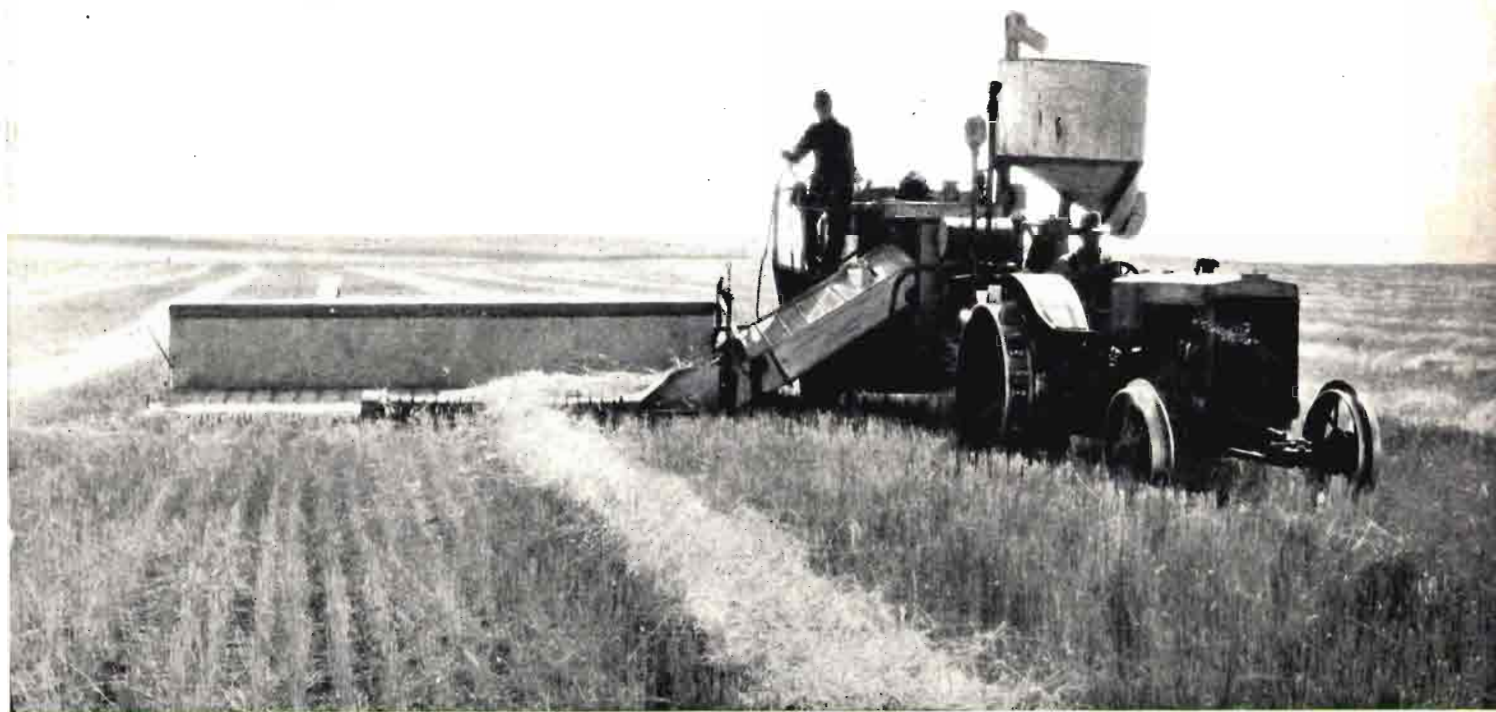
El recogedor o "pick-up", se adapta a la plataforma de la cosechadora y con su molinete de dedos elásticos levanta la hilera, transportándola a la lona que termina en el cuerpo trillador de la máquina.
