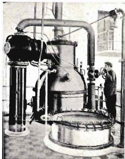
Evaporador al vacío con compresión de vapores sistema Louri-Genseke, para la concentración de mostos.
