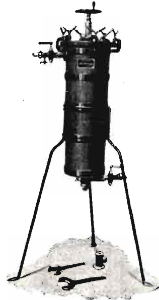
Fig. 7.ª — Filtro de discos de tejido, con caja de madera, especial para vinagres, de la casa Brewer Frères.
