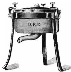
Fig. 6.ª — Filtro vinagrero "Ideal", de Schlayer, con caja de loza. La pared filtrante es de lienzo sostenido por marcos de mimbre.
