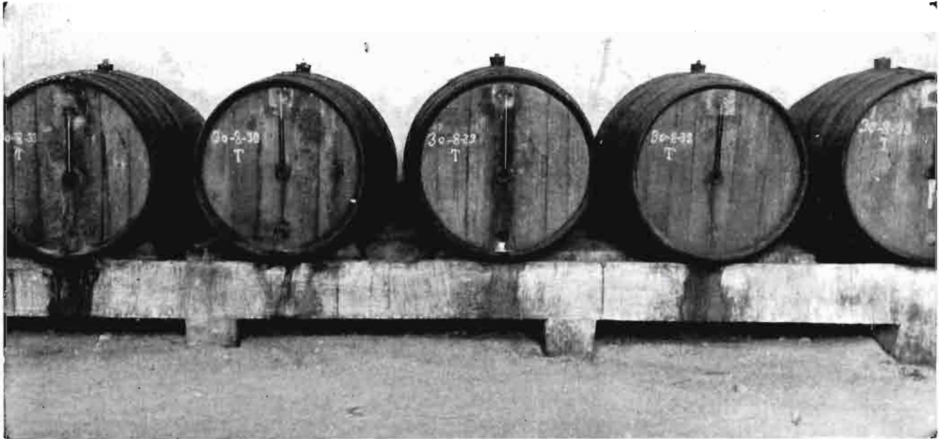
Fig. 4. a —Parte de la batería de avinagramiento por el sistema de Orleans, montada en la Escuela de Ingenieros Agrónomos. En la fotografía no son visibles las "rápes", colocadas en los extremos de la batería. Son perfectamente visibles los tubos de nivel y evacuación de líquidos en cada tonel. (Foto Aguirre Andrés.)
