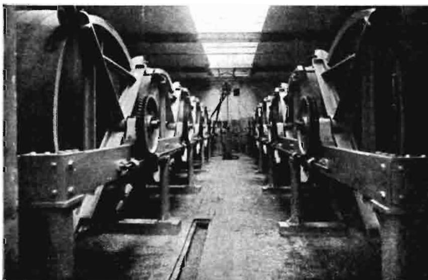
Fig. 5.ª—Ejemplo de batería de cubas o generadores rotatorios perfeccionados, patente Brewer frères; se aprecia perfectamente en la fotografía el dispositivo de sujeción de las cubas para hacerlas rotatorias mediante ruedas dentadas que engranan con un eje, dotado de tornillos sin fin, que transmite el movimiento de giro muy lento.
