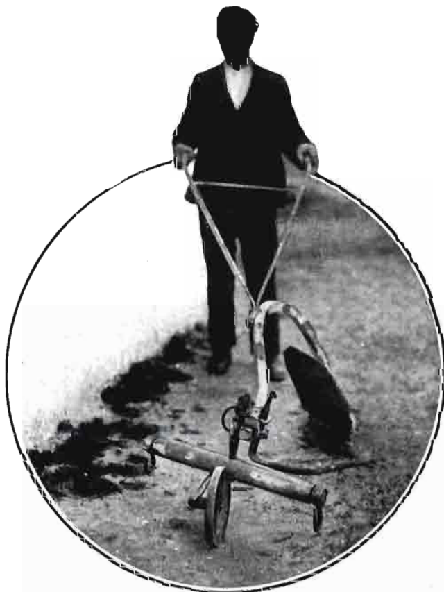
El arado Kirpy permite acercar la labor a las cepas sin peligro de dañarlas.
