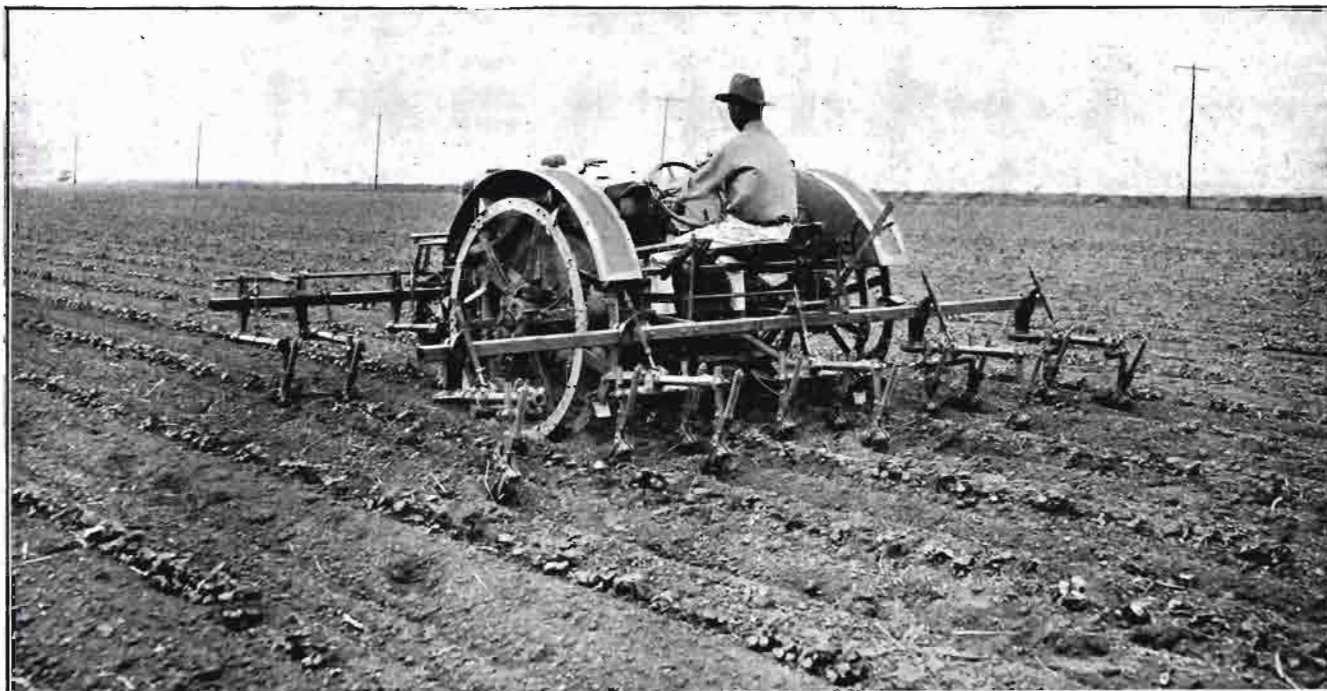
Un tractor universal adapta su anchura a la de la siembra y cultiva hasta cuatro calles simultáneamente. El árbol de fuerza sacará del suelo las rejas del cultivador, dejándolas suspendidas en el aire para girar en un radio cortísimo al final de la besana.
