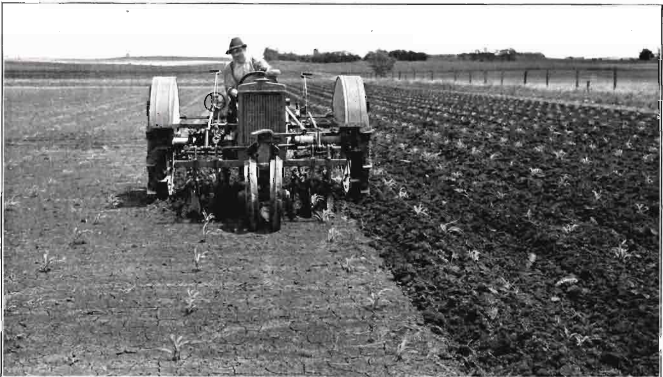
La tierra se "desangra" por las resquebrajaduras de su superficie. Único recurso para cortar las pérdidas de humedad es el mullido rápido de la siembra que este tractor de líneas hace a la perfección con discos y rejas.
