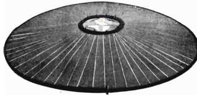
Tapadera de compensación automática característica de los silos cremasco.
