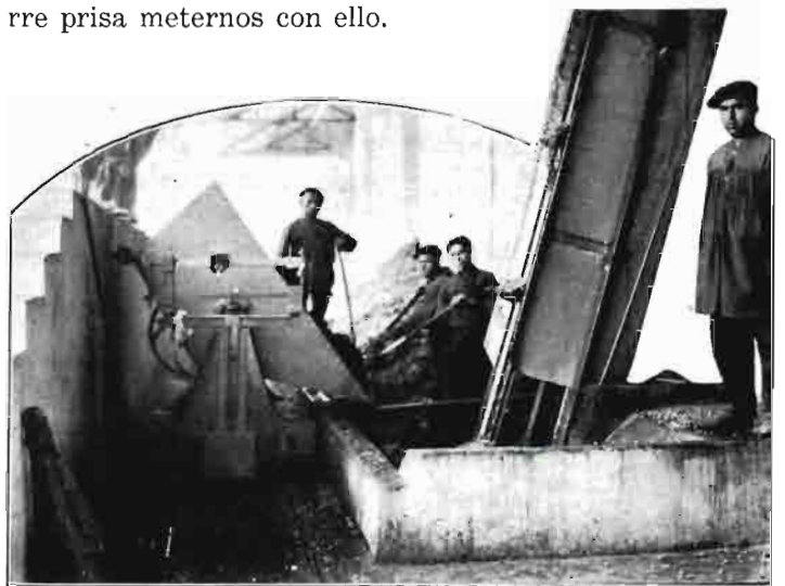
En la moderna vinificación, la vendimia es recogida en una tolva-báscula, que anota el peso. De ella pasa a un depósito de cemento, donde es recogida y elevada por un sistema de canjilones.
