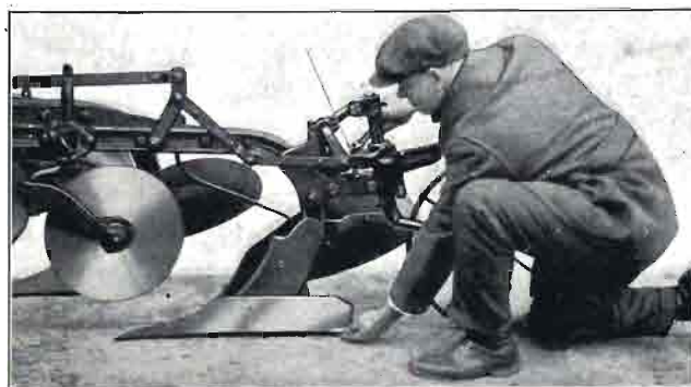
Fig. 6.—La incidencia del arado influye mucho en la tracción. Normalmente adquieren los cuerpos la posición correcta, levantando unos diez milímetros el talón trasero.
