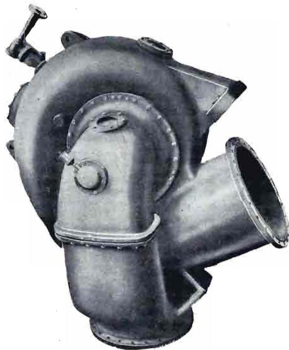
Fig. 6.—Vista exterior de una bomba centrífuga. En ella se aprecian bien la “concha de caracol”, el tubo de aspiración, en primer término, y el arranque del de impulsión (a la derecha).
