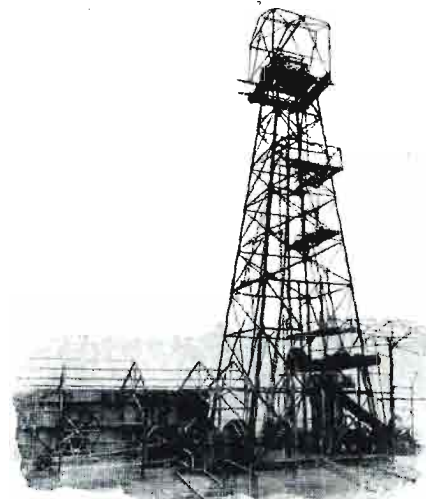
Torre de acero con perforadora a percusión para medianas y grandes profundidades.
