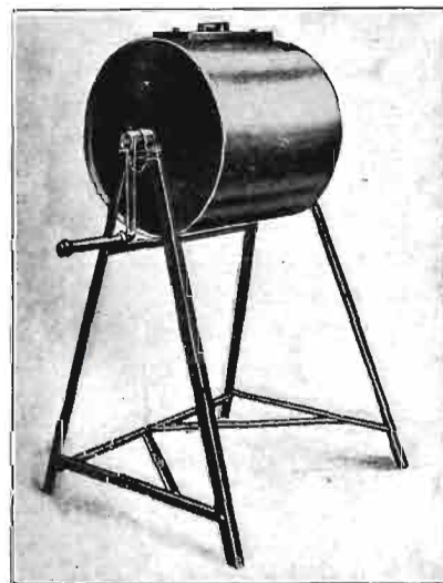
Figura 10.—Máquina Mayer, para desinfección de semillas, de trabajo continuo. (Fotos Blanco.)
