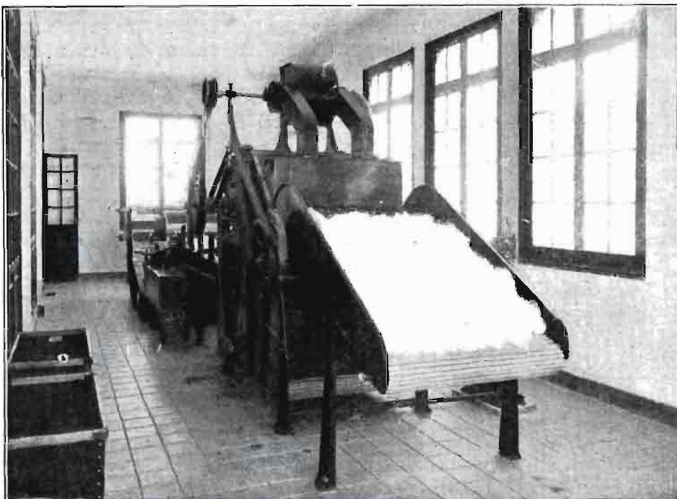
Laboratorio de hilatura. Desmotadora de ensayos acoplada a una instalación de alimentación y bataco atelador.
