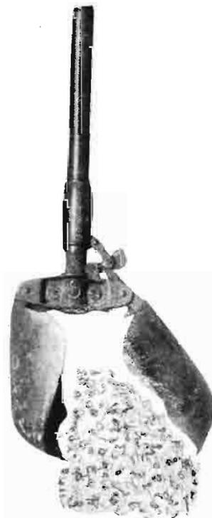
Detalle de la sonda anterior, mostrando la manera de expulsar la tierra recogida al sondar el terreno.
