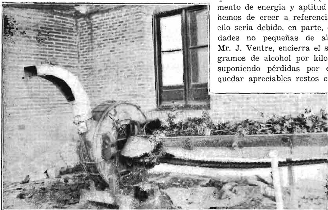
Fig. 2.—Cortaforrajes "Blizzard" picando sarmiento con hoja.
