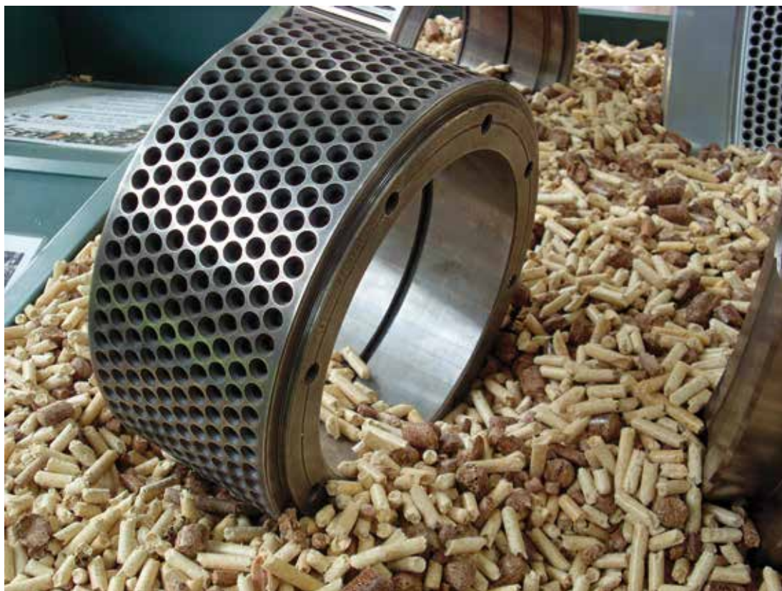
El pelet de madera, obtenido por extrusión en caliente de serrín a través de una matriz de acero, se impone actualmente como combustible alternativo al gasóleo, GLP y gas natural en prestaciones de calor, principalmente por su menor coste. Foto: L. Fdez. del Pozo.
