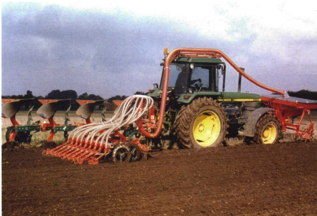
La utilización de aperos combinados permite adaptarlos a la potencia del tractor.
