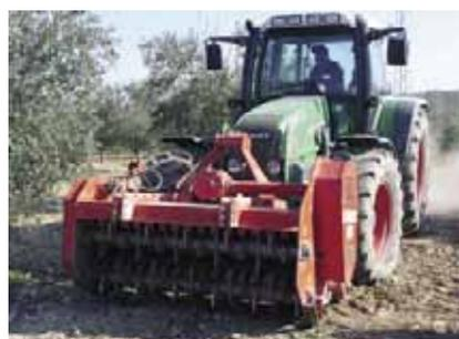
Figura 2. Tractor con tripuntal y t.d.f. delantero con una trituradora de ramón
