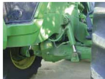
Figura 1. Suspensión del eje delantero
