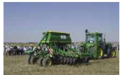
Figura 21. Sembradora directa neumática de disco de 6 metros de anchura.
