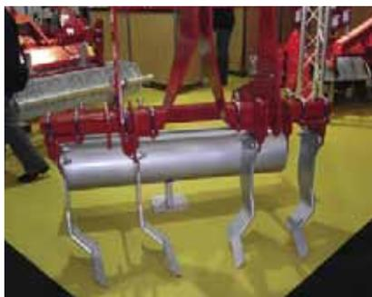
Figura 8. Rejas descompactadoras aplicables a huellas
