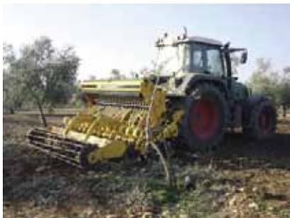
Figura 13. Tractor estándar en la siembra de una cubierta en olivar
