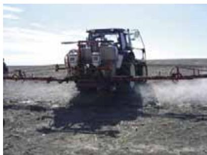
Figura 18. Barra de aplicación de herbicidas con ayuda al guiado
