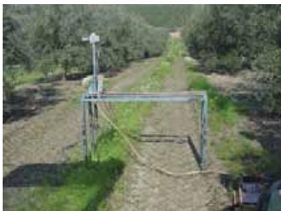
Figura 6. Daño a la cubierta por el paso de equipos de recolección. Medida de la compactación en la huella mediante penetrómetro
