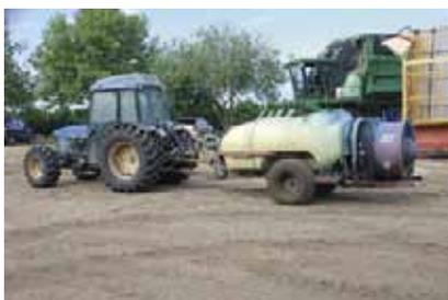
Figura 14. Tractor frutero con atomizador
