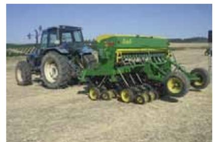
Figura 20. Sembradora directa mecánica de chorrillo con tractores de potencia media
