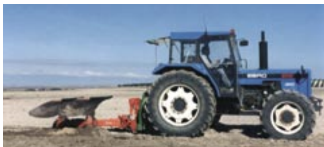
Figura 2. Tractor instrumentado (medidor de consumo, radar para velocidad, dinamómetro en enganche, posición elevador) en el ensayo de una vertedera.
