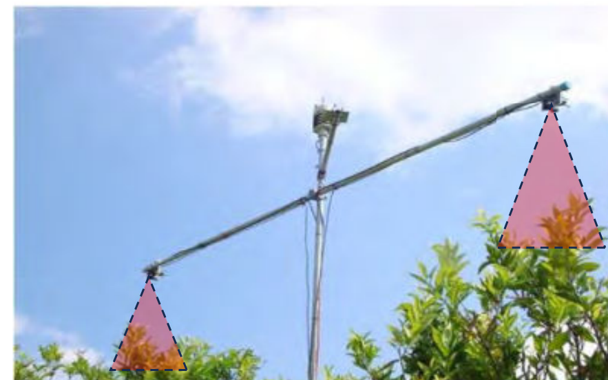
Figura: Árboles instrumentados con sensores de temperatura
