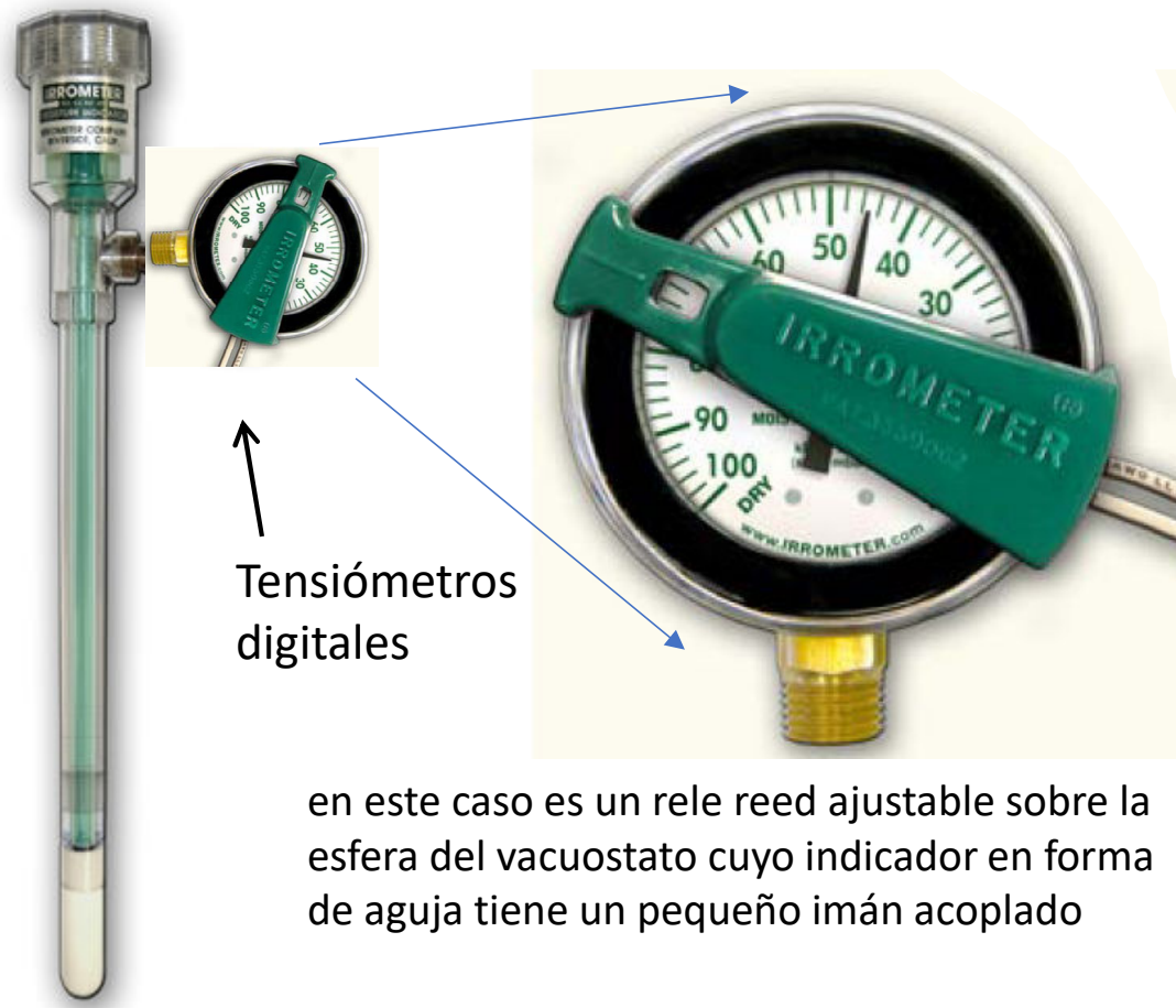
TENSIÓMETRO con Salida digital
