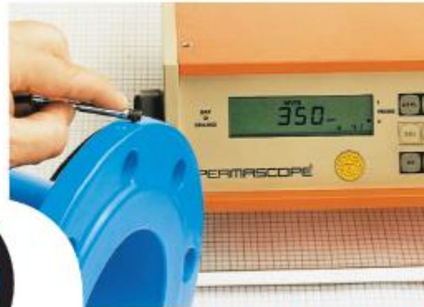
Medición del revestimiento
