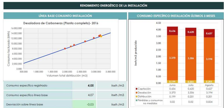
Desaladora de Carboneras: Mejora en el rendimiento detectada tras entrar el 12 de agosto en funcionamiento los nuevos recuperadores de energía en 1 bastidor
