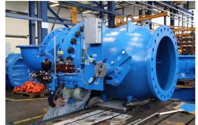
El contrapeso proporciona la energía de cierre y el cilindro hidráulico regula la velocidad a la que se efectúa el mismo
