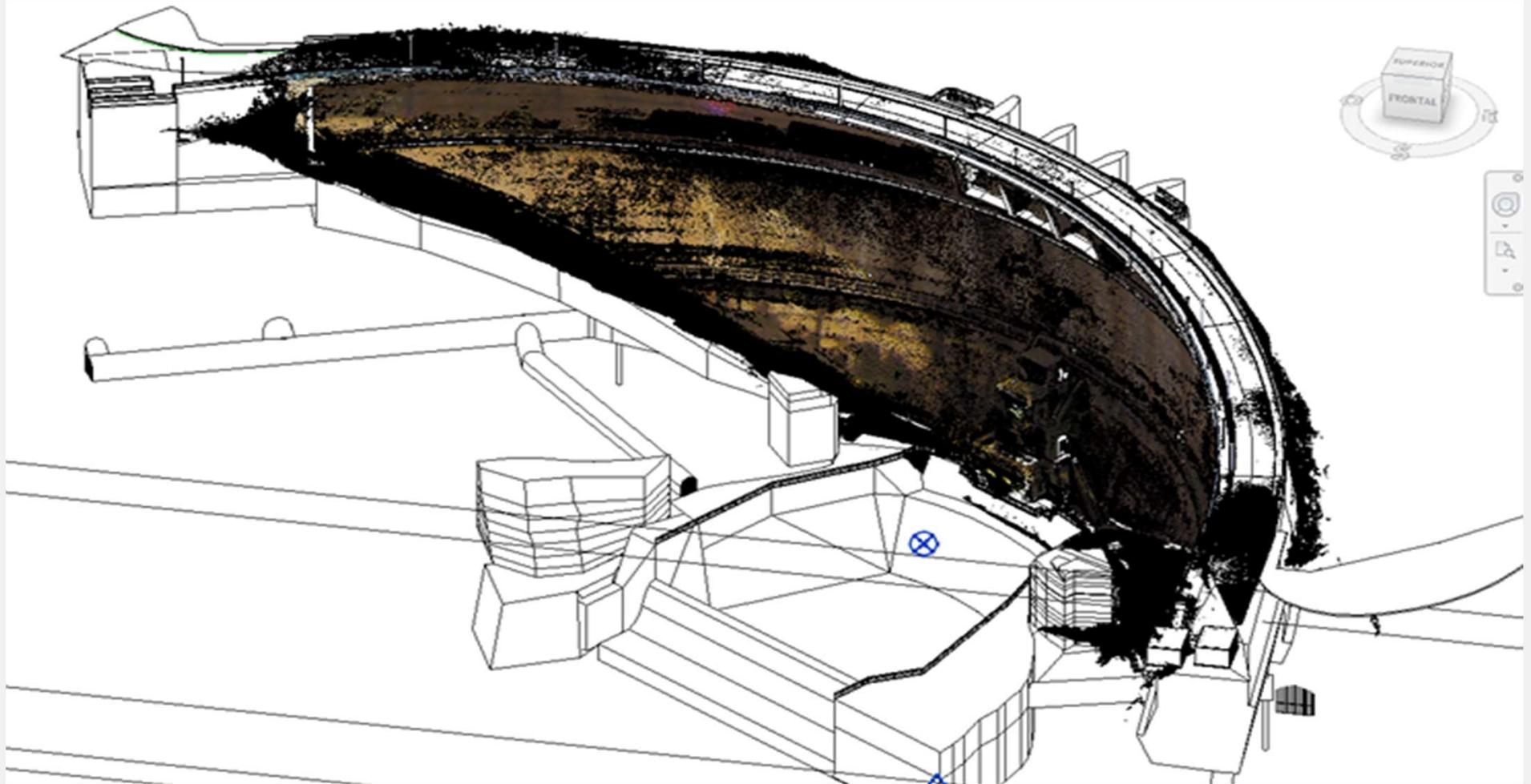
Superposición de modelo BIM con el modelo realizado con láser escáner. Fuente elaboración propia. Se ha superpuesto por coordenadas ofreciendo una diferencia de distancias en algunos puntos de 20 centímetros.
