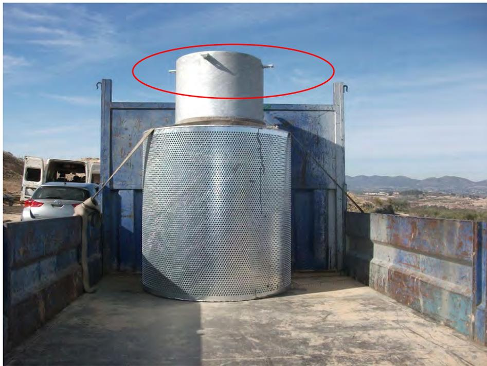
Prefiltro chapa perforada, unión a brida.
