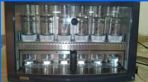
Extractor automático Soxhlet Soxtec Avanti 2050
