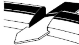
Para la colocación del anillo sobre el extremo liso del tubo, utilizar una cuña trapezoidal (ref. 158180)\* para pasarlo sobre el cordón de soldadura.
