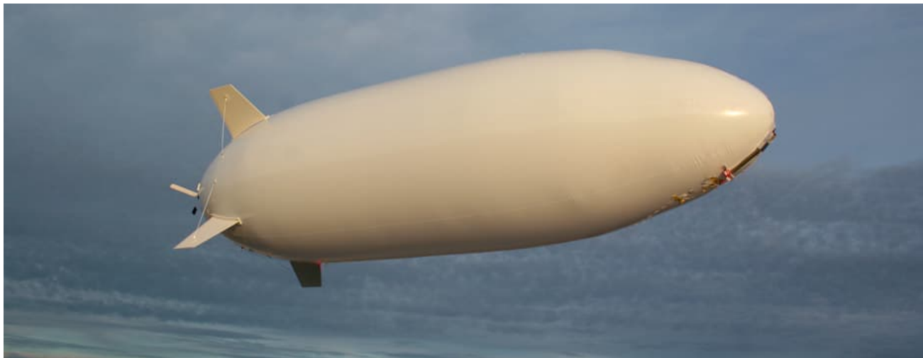
Sky Sentinel (18 horas de autonomía, altitud de 10.000 ft, 30 m de longitud y carga de pago de 136 kg)
