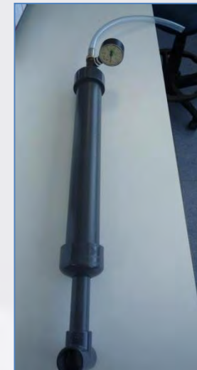
Bomba de vacío adaptada
