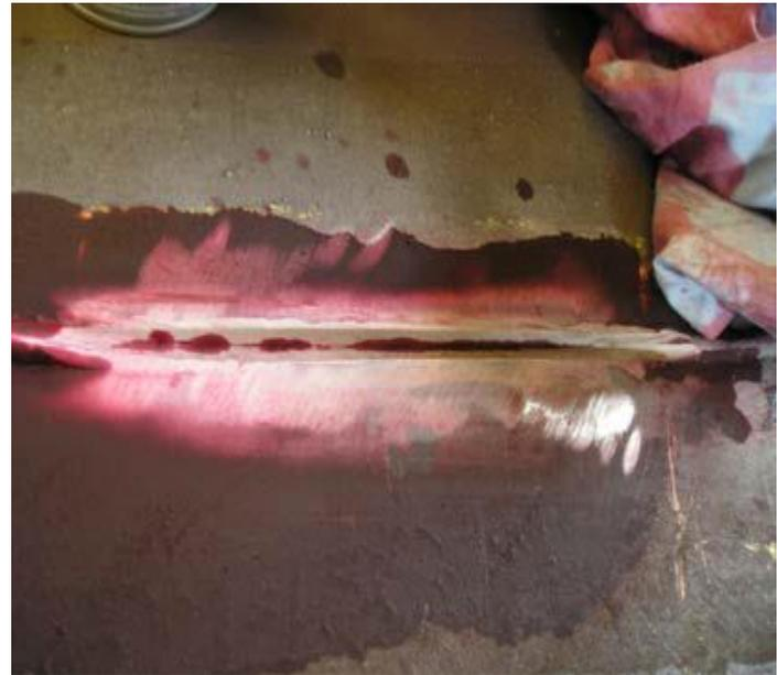
Detalles de la falta de fusión en dicha soldadura, tras la inspección por LP.
