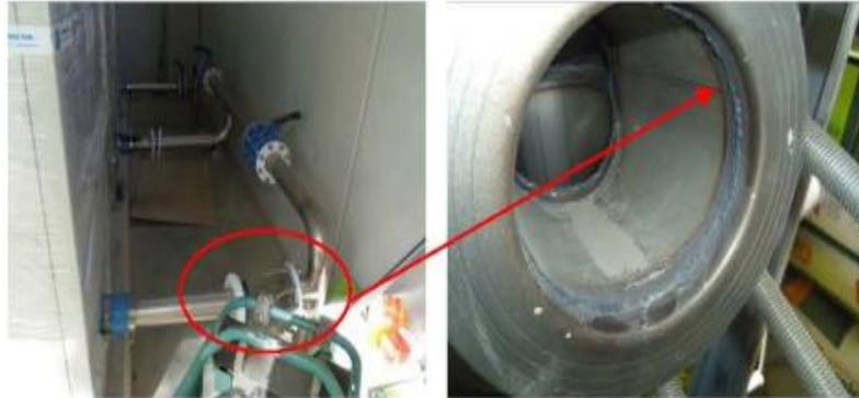
En el caso de los isométricos del biológico, se han detectado faltas de penetración en las soldaduras de unión de la tubería con la Valona de los isométricos de entrada de aire al biológico. *Estos defectos no son admisibles por la Norma UNE-EN 5817, nivel B, punto 1.5.* Se deben de subsanar.
