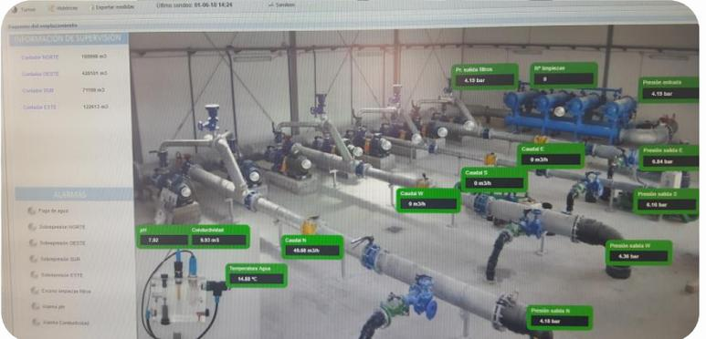
*Sectorización por sectores de cota homogénea, filtrado de limpieza automática para evitar consumos excesivos. Control parámetros bombes y sectores. Ajuste de dosis de riego a las necesidades reales de cultivo, mediante gestión de turnos específicos por cultivos. Control sobre la medición del agua aplicada.*
