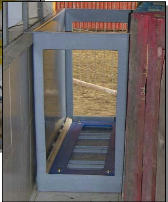
Ilustración 7. Cajón con antena Cromasa imbuida en suelo
