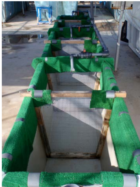
Figura 13. Tanques tabicados en 6 compartimentos (IRTA)
