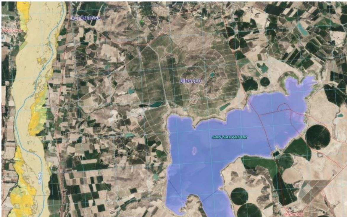
Riesgo Inundaciones periodo de retorno T100, T500 y Flujo preferente. Fuente CHE
