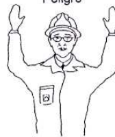
PELIGRO: ALTO O PARADA DE EMERGENCIA
