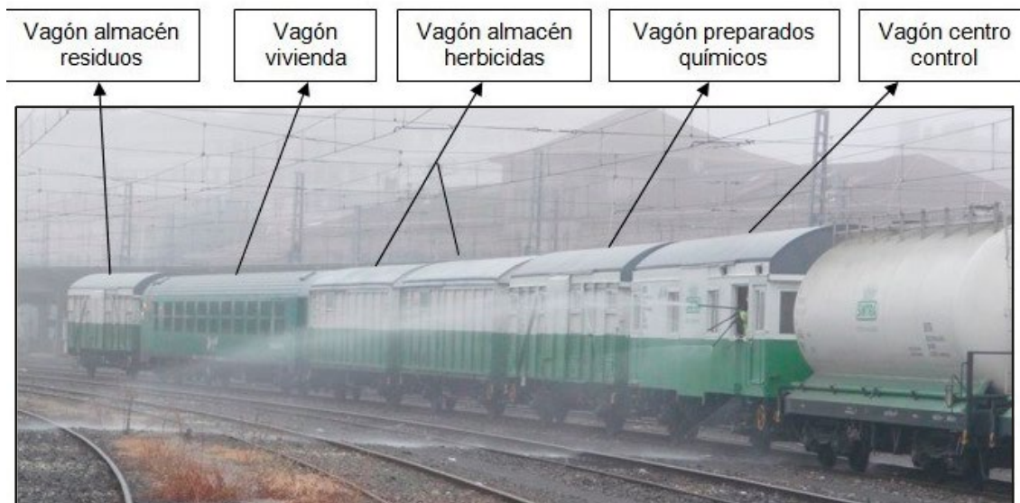
Composición ferroviaria de un tren herbicida. Imagen cedida por SINTRA
