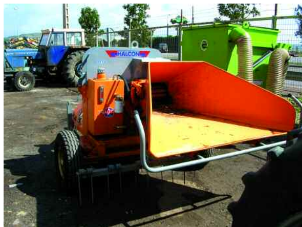
Detalle del alimentador-elevador.
