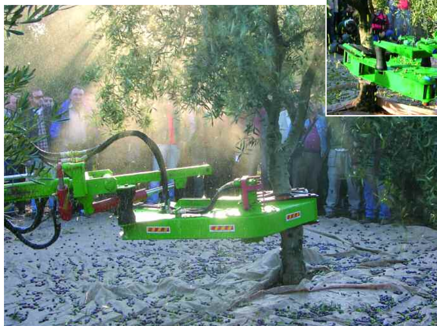
Derribo con vibrador sobre las mallas. Detalle de la pinza vibradora.
