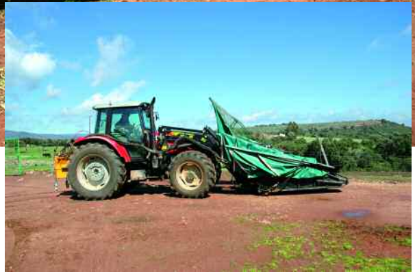
Vista lateral con vibrador y paraguas.
