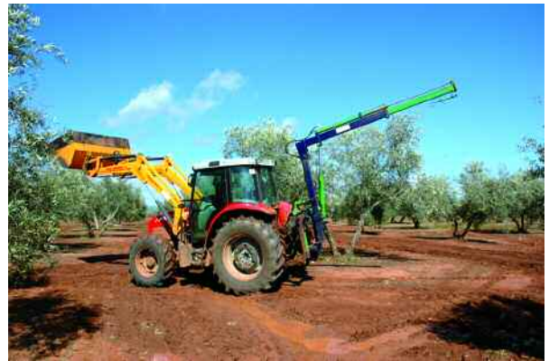
Grúa posterior adaptada a la recogida del manto en el se agrupa la aceituna mediante barrido.
